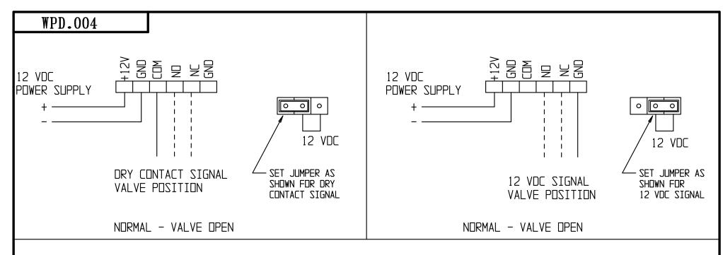
THE TERMINAL STRIP AND JUMPER ARE LOCATED ON THE CONTROL BOARD INSIDE THE FRONT COVER OF THE WATERCOP PRO ACTUATOR.
